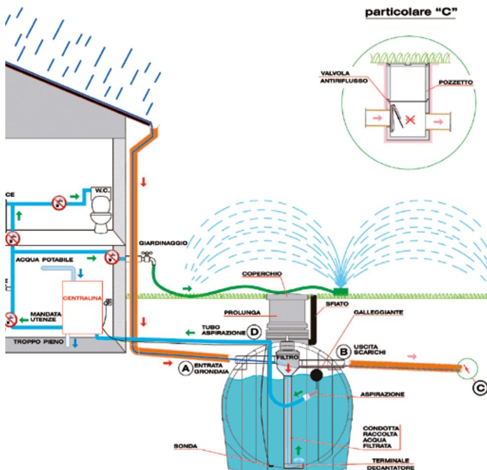
L'impianto ha lo scopo di recuperare l'acqua piovana per riutilizzarla in determinate utenze domestiche (WC, lavatrice, irrigazione, pulizie, ecc.). Esso è composto da un serbatoio da interrato, da un sistema filtrante e da una centralina di controllo.
